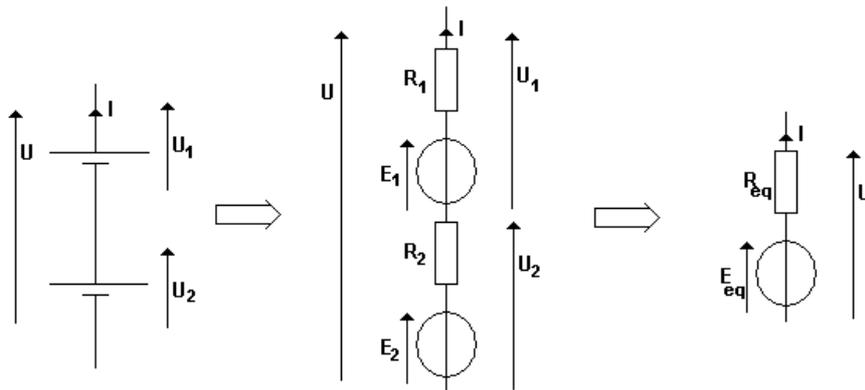
Le premier générateur a pour MET la *f.e.m.*  $E_1$  et la résistance interne  $R_1$ , le second la *f.e.m.*  $E_2$  et la résistance  $R_2$ .
