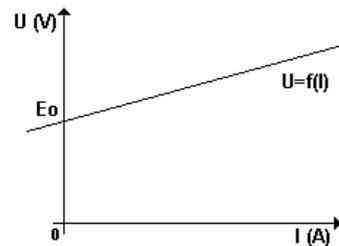
$E_0$  : tension à vide en volts, aussi appelée force électromotrice ou *f.e.m.*
